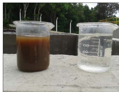
Imagem 10: Efluente no tanque de equalização e clarificado do adensador.
